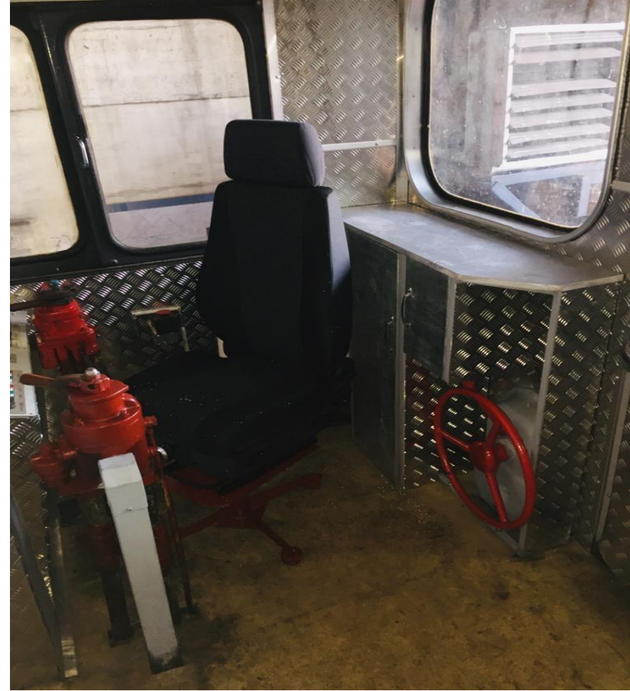
Пульт управления тепловозом и интерьер кабины машиниста тепловоза ТЭМП 1тт № 0001э (фото)
