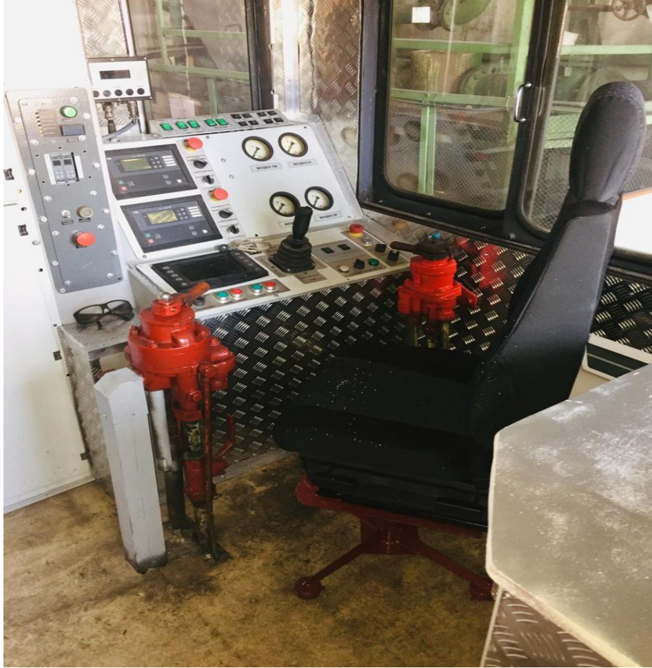
Пульт управления тепловозом и интерьер кабины машиниста тепловоза ТЭМП 1тт № 0001э (фото)
