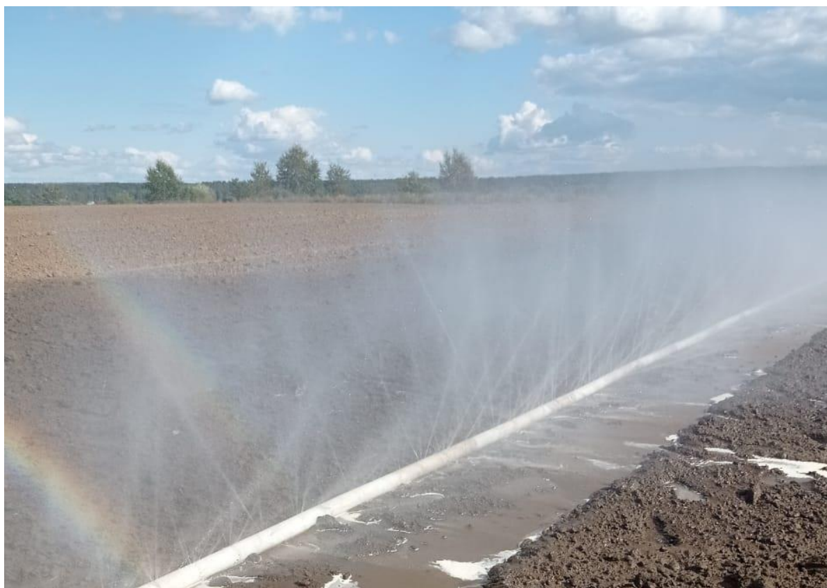
Рисунок 2 – Фрагмент испытания поливного шланга (показан на переднем крае) – образования струй воды; слева в углу – радуга
